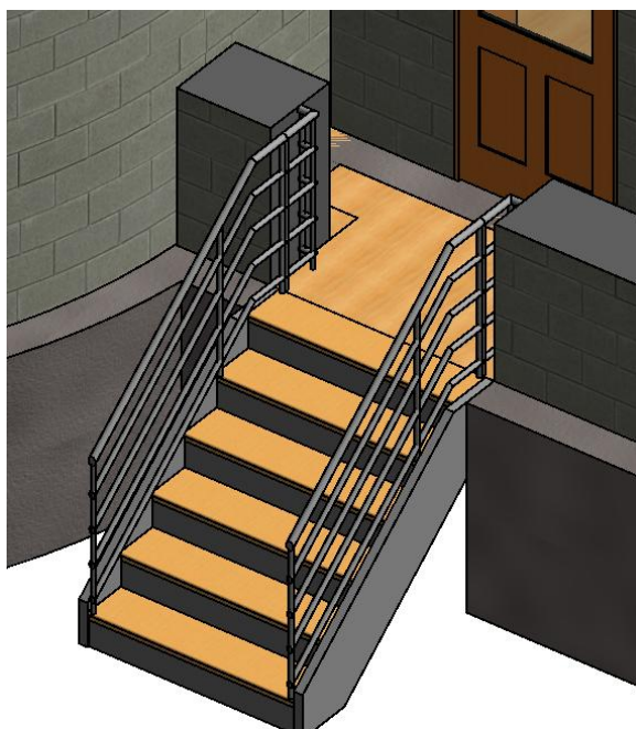
Рис. 54. Ограждение лестницы в 3D виде
